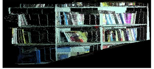
図 5 本棚正面 SIFT を用いた初期位置合わせ結果
