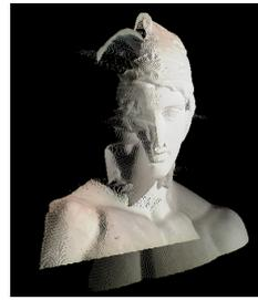
図15 LMedSとICP残差を用いた初期位置合わせ結果
