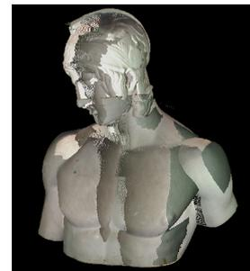
図17 石膏像正面・右側面(上部,下部)の位置合わせ結果
