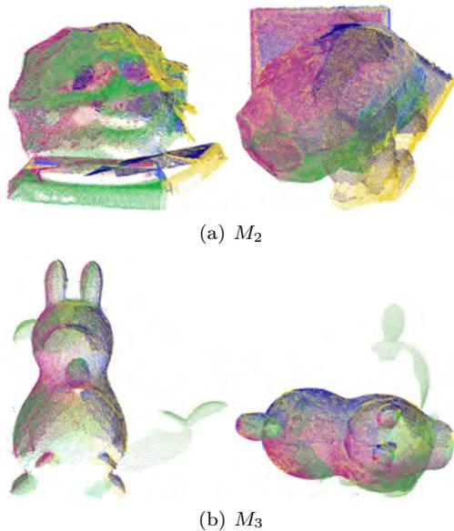
図 14 実計測データからの全周形状復元に失敗した例
