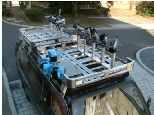
図2 車載カメラ
