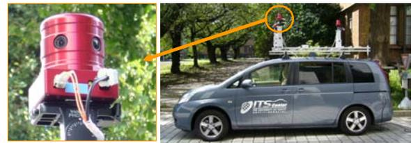
図 8 車載全方位カメラ (1 台のみ使用)
