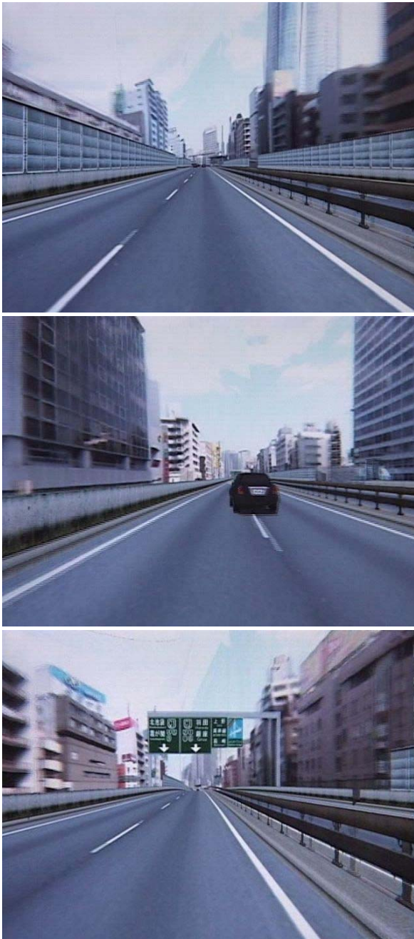
図 16 画像ベース（遠景）と幾何ベース（近景）の合成結果。空、建物、建物に付随する看板などは画像ベース、防音壁、道路、他車両、道路標識などは幾何ベースによって描かれている
