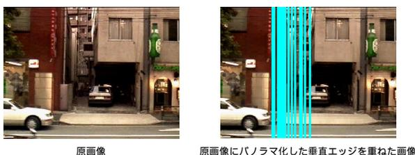
図 17 建築物の間隙における垂直エッジ
